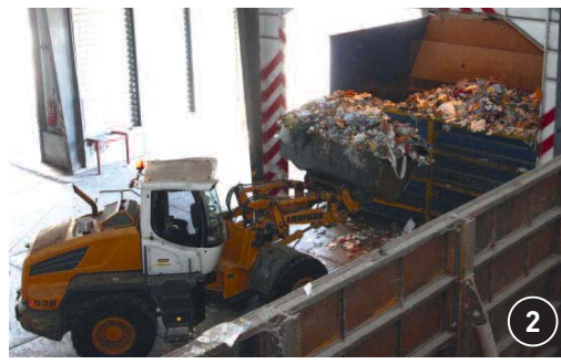
2 Les déchets sont versés dans une trémie de chargement pouvant contenir jusqu'à 6 tonnes de produits. Elle est équipée d'un ouvre-sac qui lacère les sachets afin de libérer les déchets. À la sortie de l'alimenteur, ils sont déposés sur un tapis qui les mène vers la cabine de pré-tri.
