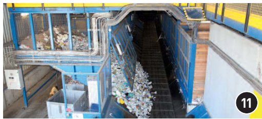
1 Les camions déposent les déchets dans une aire de stockage de 500 m 2 , cernée par des murs mobiles séparant notamment ceux issus des collectes sélectives de MPM et de la CPA. Après contrôle visuel et extraction de déchets non conformes, direction l'alimenteur de la chaîne de tri. Quant au verre, il est stocké à part avant d'être transféré, sans traitement particulier, vers les industries de recyclage.
