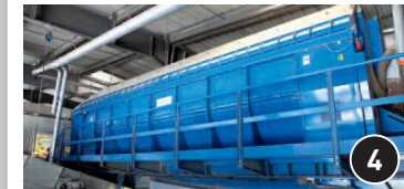
4 Les déchets admis à continuer le « voyage » passent alors par le trommel, sorte de tambour géant de lave-linge percé de trous de taille variable. Celui-ci brasse le flux des déchets et sépare les différentes matières en fonction de leur taille : les petits objets tombent alors dans la grille balistique, les moyens et les gros partent directement vers la cabine de tri manuel 5.
