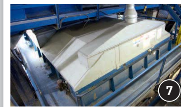
7 Dans la grille balistique, les objets sont secoués et ceux dont la taille est inférieure à 57 mm traversent la plaque et sont éliminés. Ceux qui restent sont séparés en deux flux. Les petits corps plats (journaux, cartonnettes, papiers) adhèrent à la plaque et sont dirigés vers la cabine de tri manuel 6. Les corps creux (briques alimentaires, bouteilles, flacons, canettes) sont dirigés vers un circuit complémentaire.
