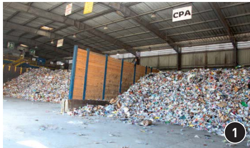
1 Les camions déposent les déchets dans une aire de stockage de 500 m 2 , cernée par des murs mobiles séparant notamment ceux issus des collectes sélectives de MPM et de la CPA. Après contrôle visuel et extraction de déchets non conformes, direction l'alimenteur de la chaîne de tri. Quant au verre, il est stocké à part avant d'être transféré, sans traitement particulier, vers les industries de recyclage.
